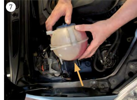
→ 9. Gewindebolzen vom Kühlmittelbehälter (2 x 10 mm) demontieren (s. Abb. 6) und diesen zur Seite legen (s. Abb. 7).
