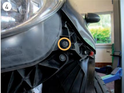
→ Befestigungsschrauben vom Scheinwerfer (3 x 8 mm) herausschrauben (s. Abb. 4 und 5) und den Scheinwerfer ein Stück nach vorne aus der Karosserie ziehen.
