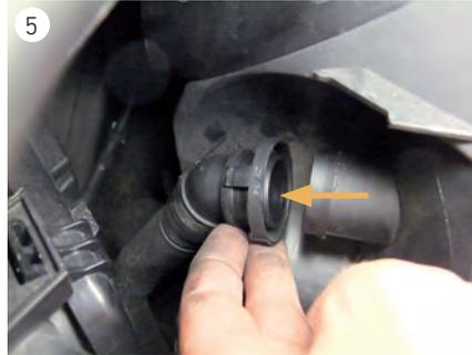
→ Stutzen vom Luftschlauch entriegeln und vom Luftfiltergehäuse abziehen (s. Abb. 5).
