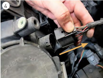
→ Arretierung der Steckerverbindung mit Hilfe eines Schraubendrehers lösen und den Stecker abziehen (s. Abb. 4).
