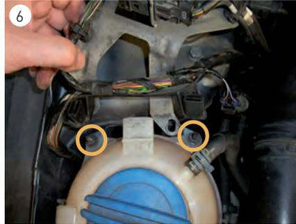
→ Schrauben (2 x 10 mm) abschrauben und den Metallhalter demontieren (s. Abb. 6).
