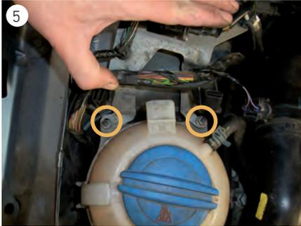
→ Kabelführung nach oben von den Gewindebolzen abziehen und Befestigungsschrauben (2 x 10 mm) abschrauben (s. Abb. 5).
