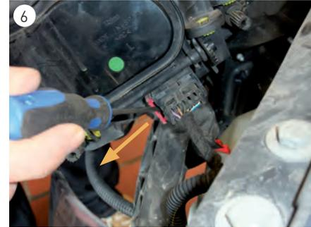
→ Steckerverbindung am Scheinwerfer entriegeln und diesen vom Scheinwerfer abziehen (s. Abb. 6).
