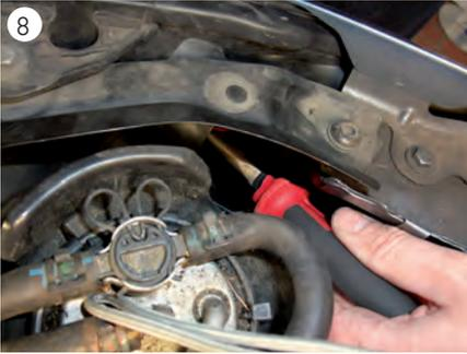
→ Gummikappe vom Positionslicht abziehen. Die Lampenfassung ist tief im Scheinwerfer verbaut. Mit Hilfe einer Spitzzange die Lampenfassung vorsichtig nach hinten aus dem Reflektor ziehen (s. Abb. 8).
