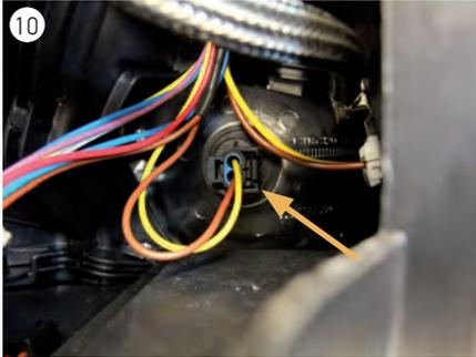
→ Die Lampenfassung sitzt sehr tief im Scheinwerfer und ist nicht mit den Fingern erreichbar. Daher mit einem geeignetem Werkzeug, z. B. einer Spitzzange, den Lampensockel vorsichtig nach links verdrehen und diesen mit der Glühlampe aus dem Reflektor nehmen (s. Abb. 10).
