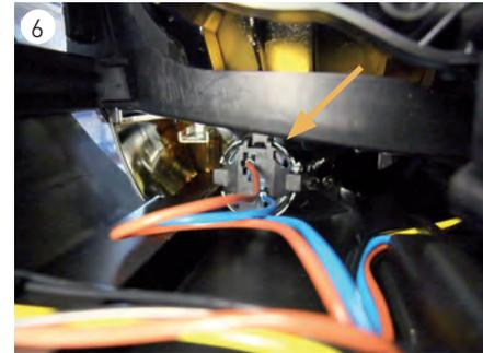
→ Bei der Montage der neuen Lampe ist darauf zu achten, dass der Glühlampenfuß plan an der Lampenfassung anliegt.
