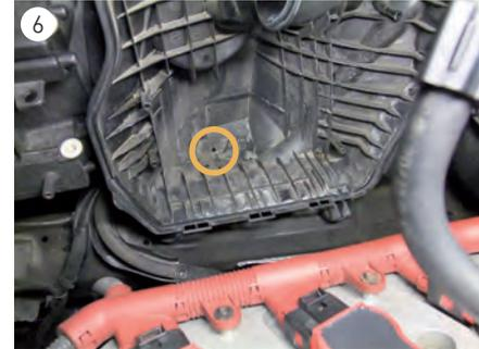
→ Gummibolzen im unten Teil vom Gehäuse nach oben herausziehen (s. Abb. 6).
