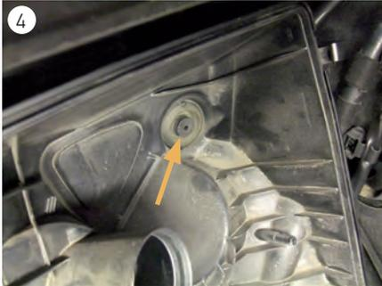
→ Spreizglied aus dem Befestigungsstopfen herausziehen (s. Abb. 4). Anschließend den hinteren Gehäuseteil zum Motor hin, von der Kotflügelwand abziehen.
