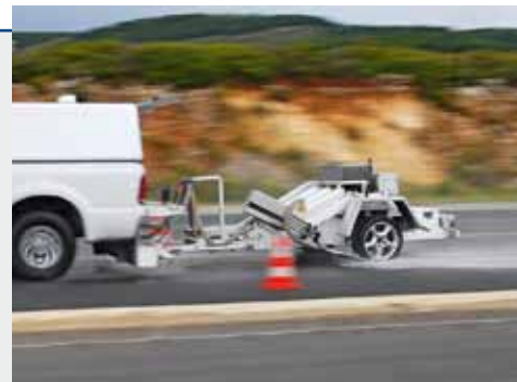
NASSBREMS-TESTS mit Spezialanhänger
