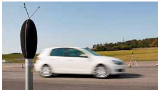
Das Testauto fährt zwischen zwei Mikrofonen hindurch, die den erzeugten Schallpegel aufnehmen
