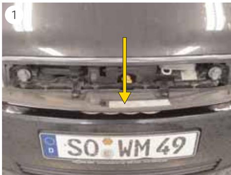
Um in den Motorraum zu gelangen, muss die Motorhaube ausgebaut werden.
