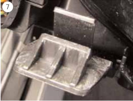
Alle ausgebauten Teile wieder in umgekehrter Reihenfolge einbauen. Beim Einsetzen des Scheinwerfers ist darauf zu achten, dass die unteren beiden Halterungen des Scheinwerfers (s. Abb. 7) wieder ordnungsgemäß an der Karosserie einrasten.
