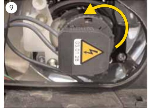
■ Zündmodul nach links drehen und von der Xenonlampe abziehen (s. Abb. 9).
