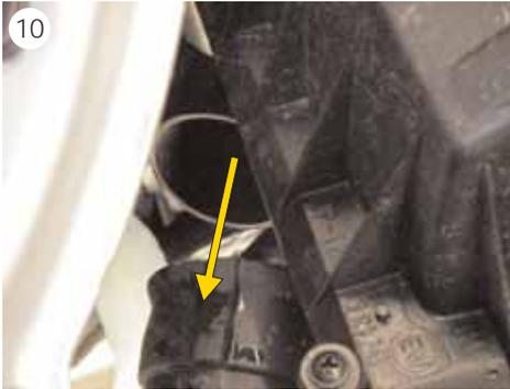
Ansaugluftkanal aus den Langlöchern nehmen und anschließend vom Luftfilterkasten abziehen (s. Abb. 10).
