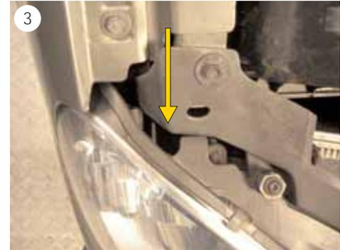
Die Schraube in Abb. 3 kann nur mit einem langen Schraubendreher, oder einer entsprechenden Knarrenverlängerung erreicht werden.
