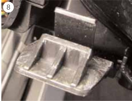
Alle ausgebauten Teile wieder in umgekehrter Reihenfolge einbauen. Beim Einsetzen des Scheinwerfers ist darauf zu achten, dass die unteren beiden Halterungen des Scheinwerfers (s. Abb. 8) wieder ordnungsgemäß an der Karosserie einrasten. Lichtanlage auf einwandfreie Funktion hin prüfen. Scheinwerfereinstellung prüfen und ggf. einstellen.
